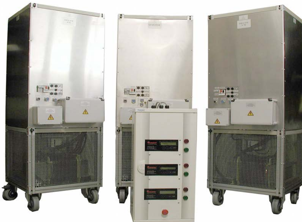
Banc triphasé composé de 3 modèles ET1524 en configuration "maître - esclave"
