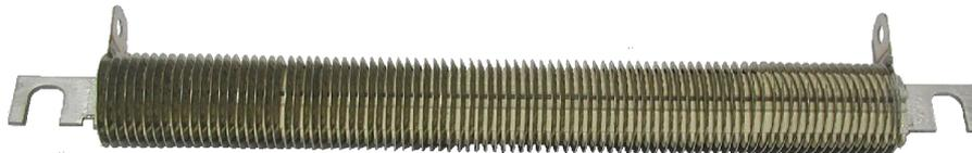
Les résistances M17 sont construites sur le même principe de structure mécanique que les résistances BC, mais avec une ferrure centrale et des cavaliers céramiques différents d'où un mode de fixation et un pas de l'enroulement différents.
